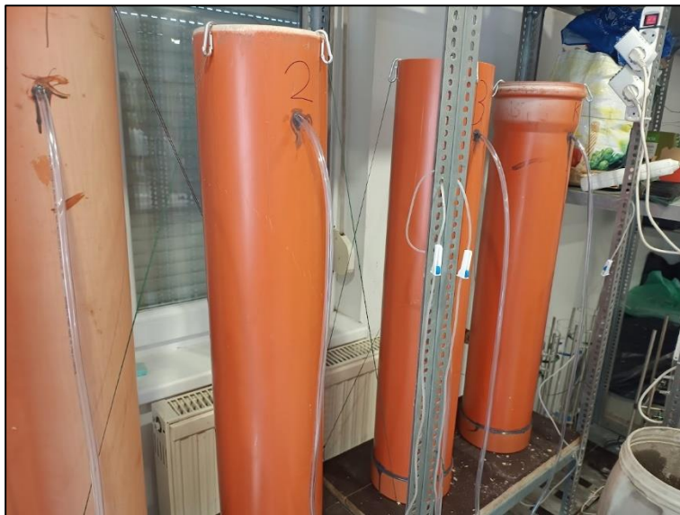
Töltött oszlopos kísérletek során alkalmazott rögzítés és elhelyezés
