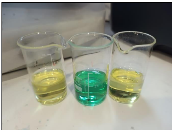
A mintákon az \text{NH}_4\text{-N} mérés reagenseinek hozzáadását követő színváltozás
