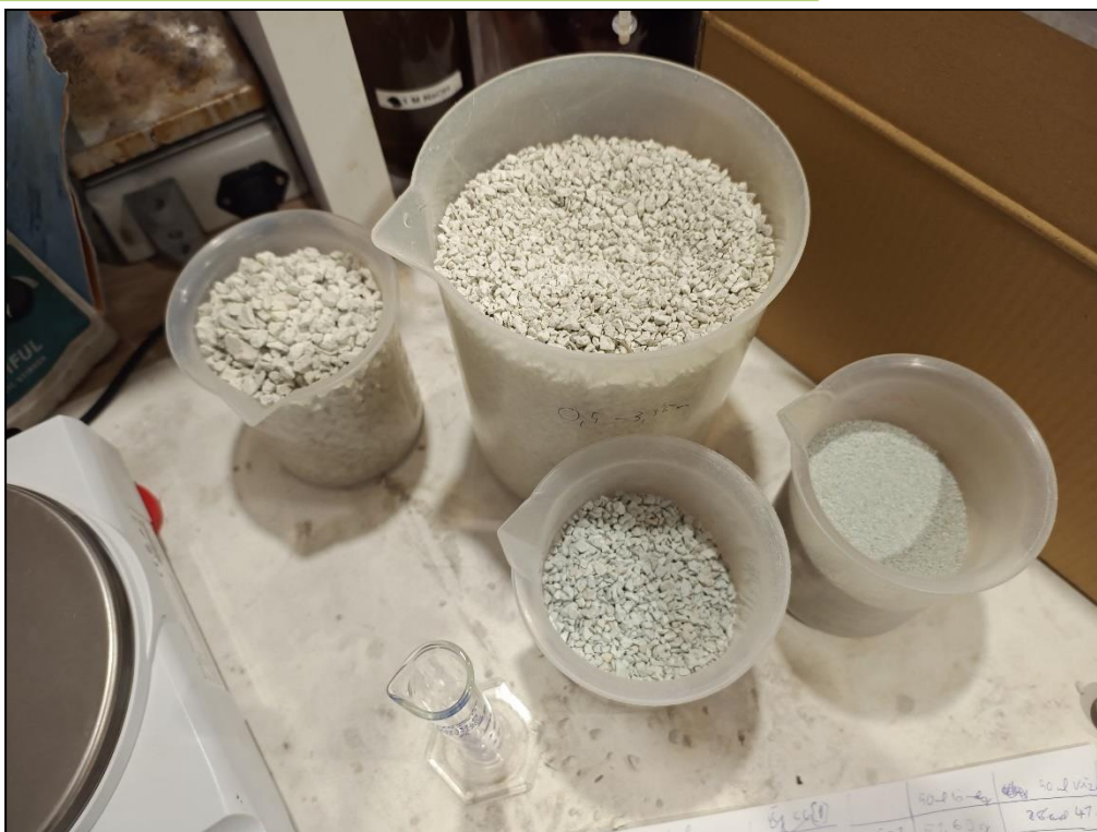
Különböző zeolit szemcseméret szétválasztás követően
