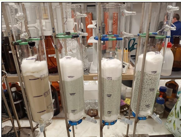
Az adszorbenses reaktorok feltöltése szűrővattával
