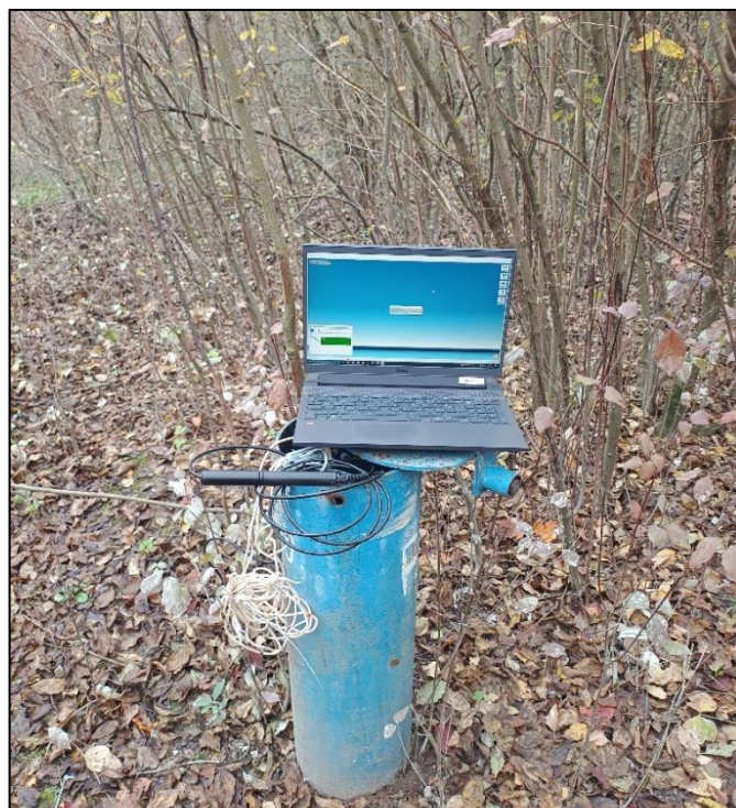
Figyelő kutakhoz kibehelyezett vízszint rögzítő szonda paraméterezése a helyszínen
