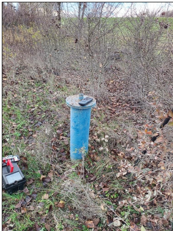
Figyelő kutak pontos koordinátáinak meghatározása, tengerszint feletti magasság meghatározása GNSS RTK GPS segítségével
