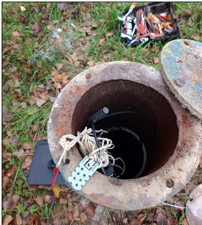
Figyelő kutakban elhelyezett vízszint rögzítő szonda
